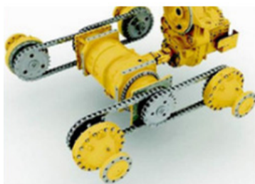
Рис. 6. Багатошківна ланцюгова передача з натяжним роликком для ходової системи автомобіля
